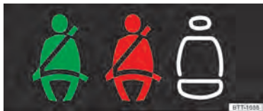
Рис. 20 На дисплее комбинации приборов: состояние ремней безопасности задних сидений.
