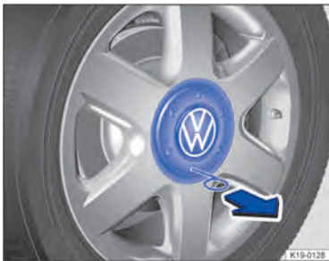
Рис. 187 Снятие обшивки центрального колеса путем стаскивать.
