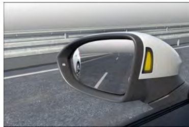
Рис. 113В корпусе наружного зеркала заднего вида: визуальные индикаторы системы смены полосы движения.
