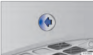
Рис. 169В переднем бампере справа: снятие накладки.
