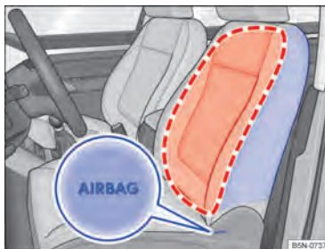
Рис. 37Со стороны переднего сиденья: расположение и зона срабатывания боковой подушки безопасности.
