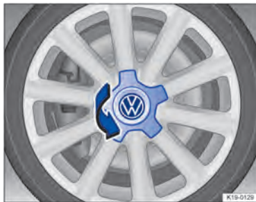
Рис. 188 Снятие обшивки центрального колеса путем превращения.
