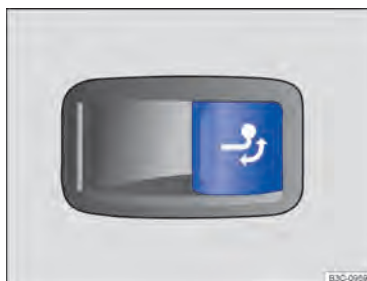
Рис. 136 Справа в багажном отделении: кнопка разблокировки шаровой сцепки.
