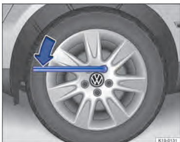
Рис. 191 Замена колеса: ослабление колесных болтов.
