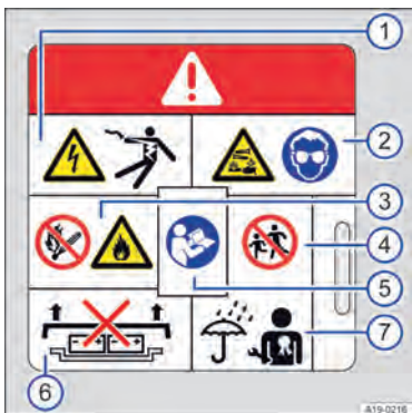
Рис. 141 Предупреждающий знак о высоковольтной батарее.
