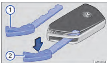
Рис. 55 Ключ автомобиля: открытие крышки аккумуляторного отсека.
