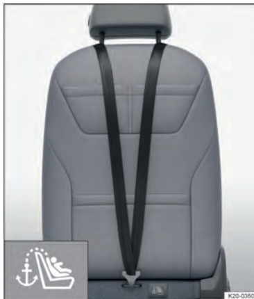
Рис. 48На задней части сиденья переднего пассажира: прикреплен верхний трос.
