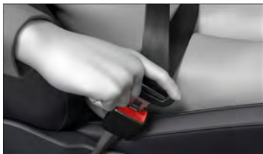
Рис. 26 Вставьте защелку ремня безопасности в замок.
