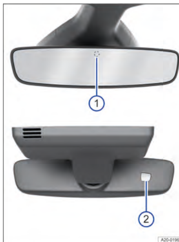
Рис. 94 На лобовом стекле: внутреннее зеркало с автоматическим затемнением.
