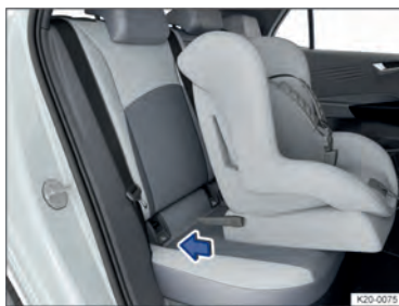
Рис. 46 Иллюстрация: установка детского сиденья с помощью кронштейнов крепления.
