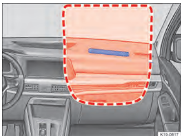
Рис. 34 Расположение и зона срабатывания фронтальной подушки безопасности переднего пассажира.
