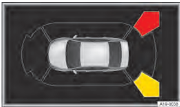
Рис. 120B Информационно-развлекательной системе: Дисплей предупреждения о движении сзади.
