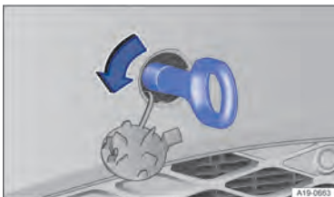
Рис. 170В переднем бампере справа: вкручивание буксирной проушины.
