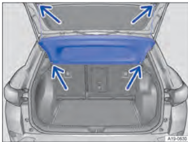
Рис. 125 В багажном отделении: снятие-установка и установка полки багажного отделения.
