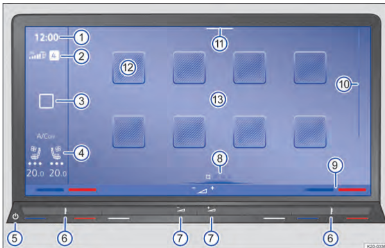
Рис. 123 Обзор: блок дисплея и управления в версиях 10 дюймов (10 дюймов) и 12 дюймов (12 дюймов).
