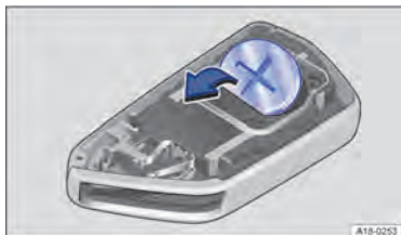
Рис. 56 Автомобильный ключ: замена кнопочной ячейки.
