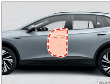
Рис. 36В салоне с левой стороны автомобиля: зона срабатывания боковой подушки безопасности.
