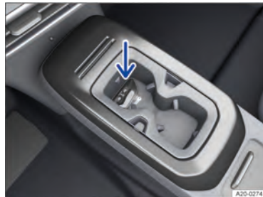
Рис. 99 В центральной консоли: аварийный запуск функция.
