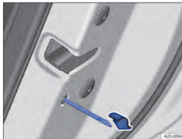
Рис. 62 В торце правой двери: запирание автомобиля вручную запасным ключом.
