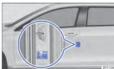
Рис. 184 На стойке двери водителя: наклейка с давлением в шинах (как вариант на внутренней стороне лючка зарядного гнезда).
