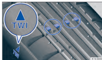
Рис. 185 Протектор шины: индикаторы износа протектора.
