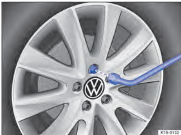
Рис. 196 Замена колеса: Открутите колесные болты с помощью колесного ключа.
