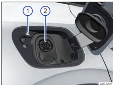
Рис. 1453а крышкой гнезда для зарядки сзади справа: гнездо для зарядки.
